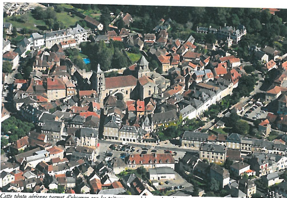
Cette photo aérienne permet d'observer que les toitures en ardoises, qui se démocratisent au cours du XIX e siècle, sont plutôt positionnées sur les boulevards, en périphérie des cœurs d'îlots où la tuile plate domine.
